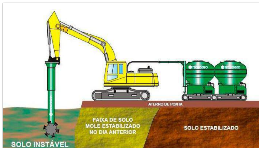
Figura 7: Desenho esquemático com processo executivo da mistura de massa – técnica Stabtec [Fonte: Keller Tecnogeo].
