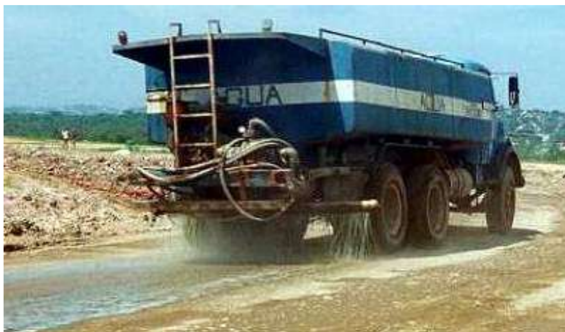
Figura 25 - Irrigação de vias internas do AMJG com chorume espalhado por caminhões pipa
